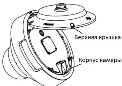
Рисунок 2-17 Верхняя крышка камеры PanoVu
